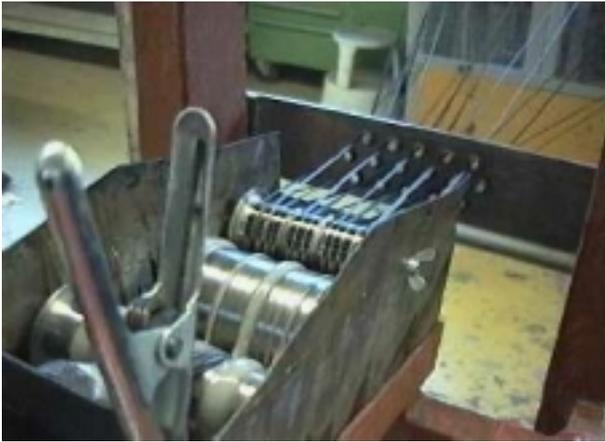
*Bild <8>: Dezember 1999: Rovingstränge laufen in die Tränkmaschine...*
