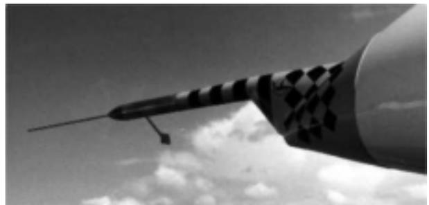
Bild <3>: Montierte Nasensonde auf dem DuoDiscus
