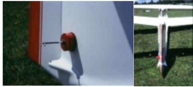
Bild 4: Anbau des Heckballastes an der ASK 21
