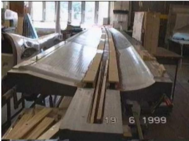
*Bild <4>: Sommer 1999: Zur Fertigung der Holmgurte werden Formen gebaut*
