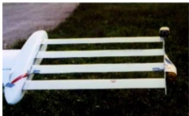
Bild<9>: WingGrid im Detail mit CCD-Kamera und einer Rauchpatrone
