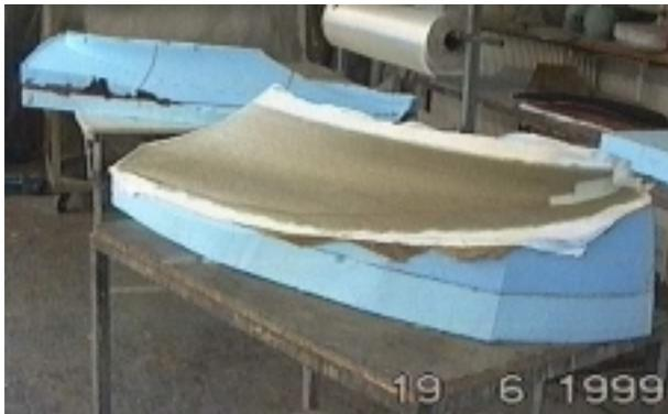
*Bild <5>: Sommer 1999: Auf vorgefrästen Kernen werden die aerodynamischen Anformungen für den Flügel-Rumpf-Übergang hergestellt.*
