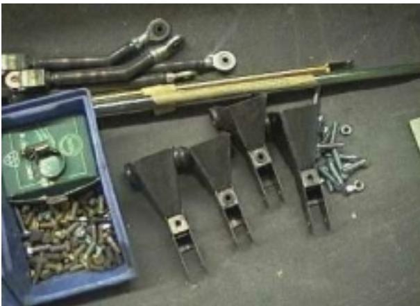
*Bild <16>: Dezember 1999: Steuerungsteile für den Rumpf, automatische Ruderanschlüsse für den Tragflügel*
