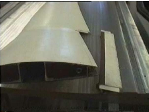
*Bild <1>: Winter 98/99: Querruder am Aussenflügel werden abgetrennt*
