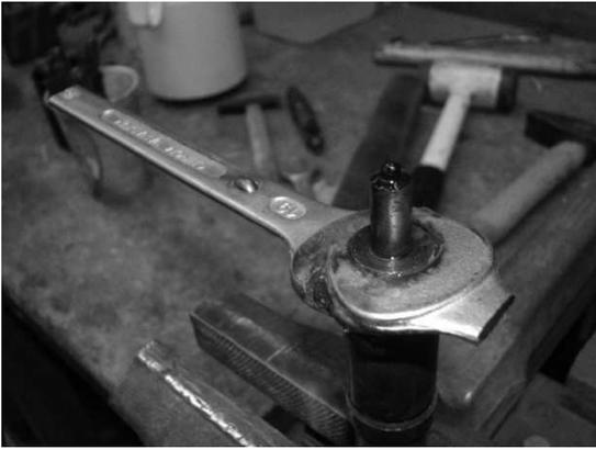
Abbildung 1.6: AKA-Werkzeugbau. Einfache Gabelschlüssel hatten sich aufgebo-gen...
