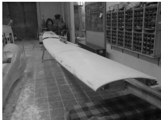
*Abbildung 1.1: Die Fläche fertig zum Verbohren*
