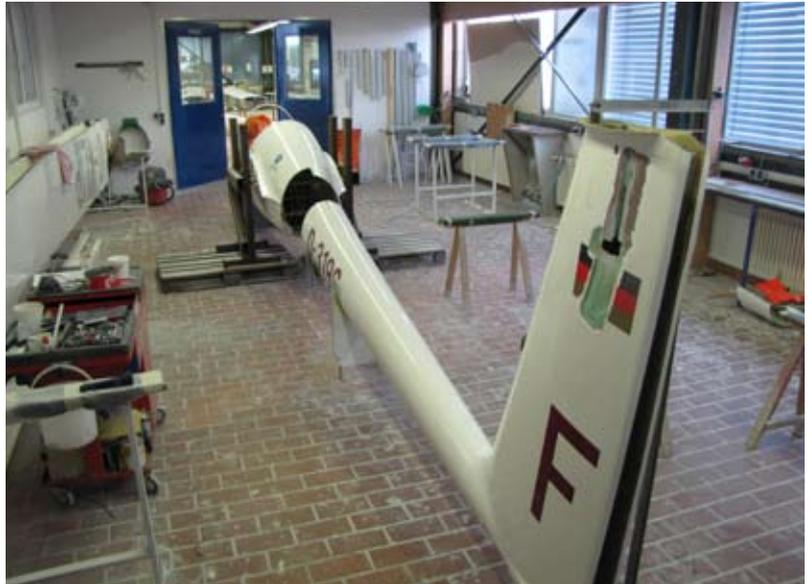
Bevor die zweite Hälfte eingeklebt werden konnte, mussten noch die durch den Bruch unterbrochenen Leitungen, Steuerseile, Führungen und Schläuche wieder verbunden werden. Nachdem dann auch noch die Verstärkungsstreifen entlang der Längskanten an der Mittellinie eingeklebt waren, lief das Anpassen und Einschäften der zweiten Reparatur-Halbschale analog der ersten Hälfte ab.
