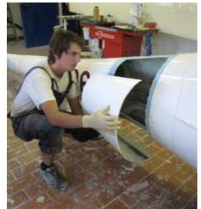
Der letzte Schritt zur sicheren Verbindung der Rumpfteile war die äußere Schäftung. Dazu wurden die zusammengefügte Teile an den Nahtstellen entsprechend den Vorschriften angeschragt und diese dann mit den im RHB definierten mit Harz getränkten Glasfaserar-
