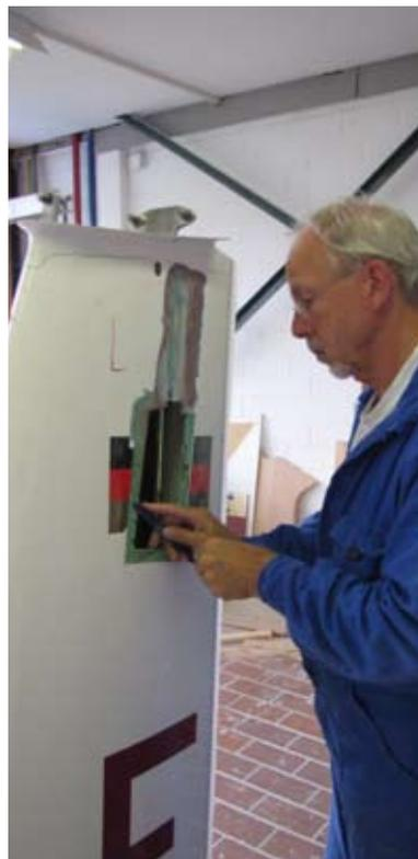
Etwas verzwick, weil schwer zugänglich, stellte sich das Ablängen und Einbauen der neuen Stahlseile für das Seitenruder dar.
