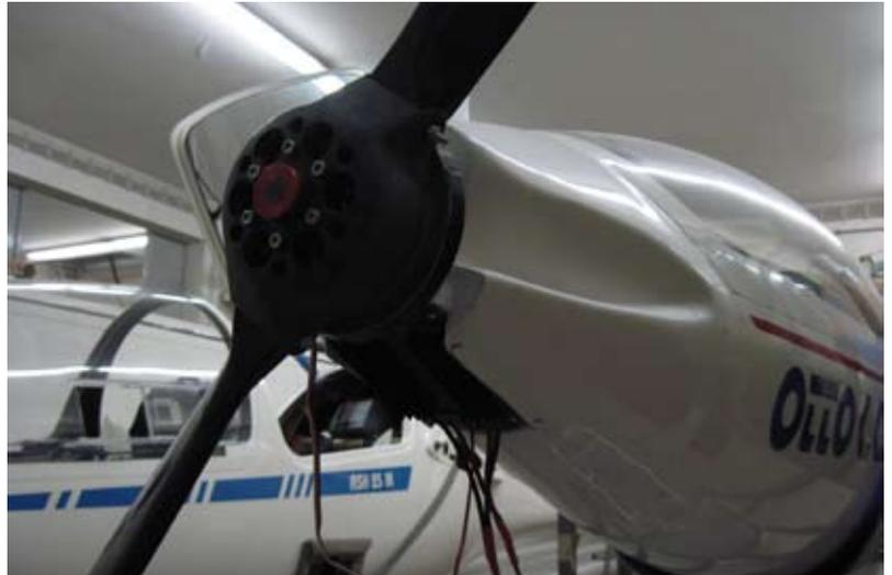
Elektromotor mit Spinner, Propeller ausgeklappt
