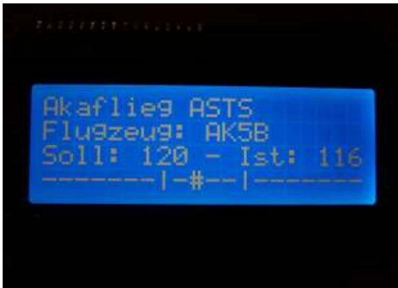
Display für die Winde mit Anzeige von Flugzeugtyp, Soll- und Istgeschwindigkeit
