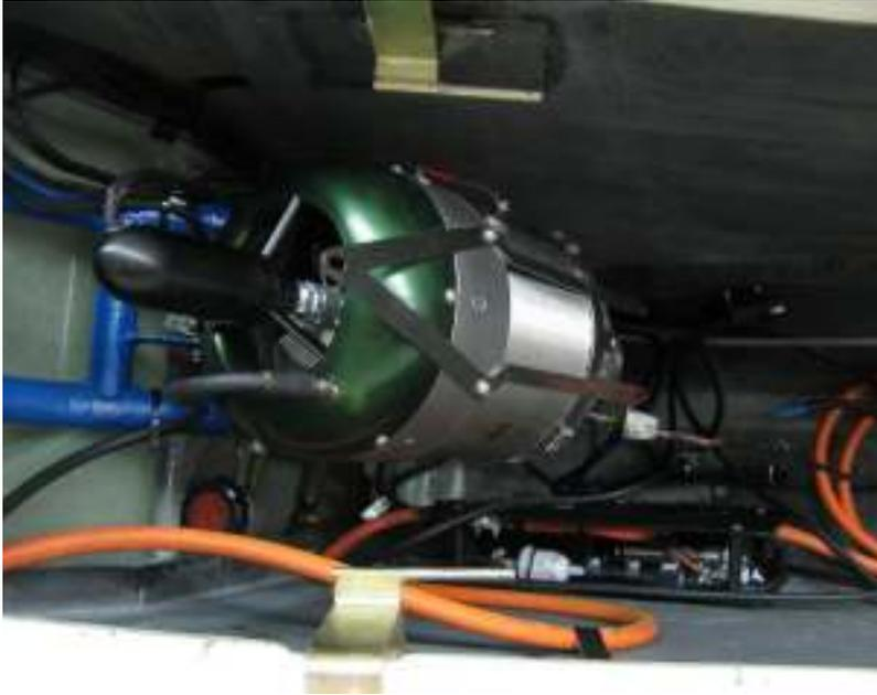
Eingefahrenes Turbinenriebwerk im Motorkasten der DG-1000
