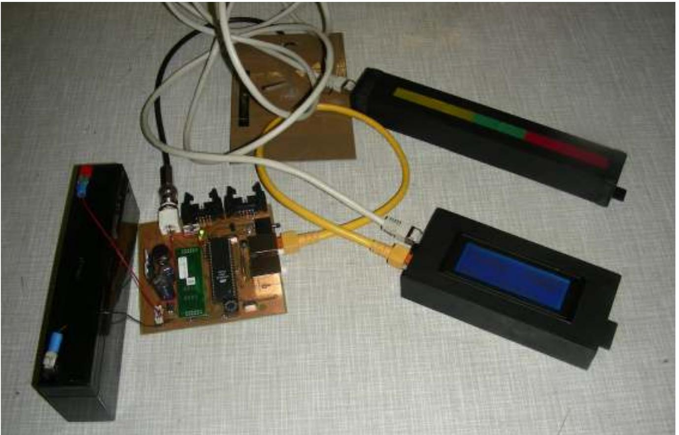
Die Hardware ist bis auf das Audio-Modul fertig entwickelt. Es wurden Prototypen hergestellt, die für Tests demnächst eingebaut werden können. Sobald der Prototyp funktioniert, können dieselben Platinen in etwas größerer Stückzahl hergestellt werden, die dann ggf. in alle Akaflieg-Flugzeuge eingebaut werden.
