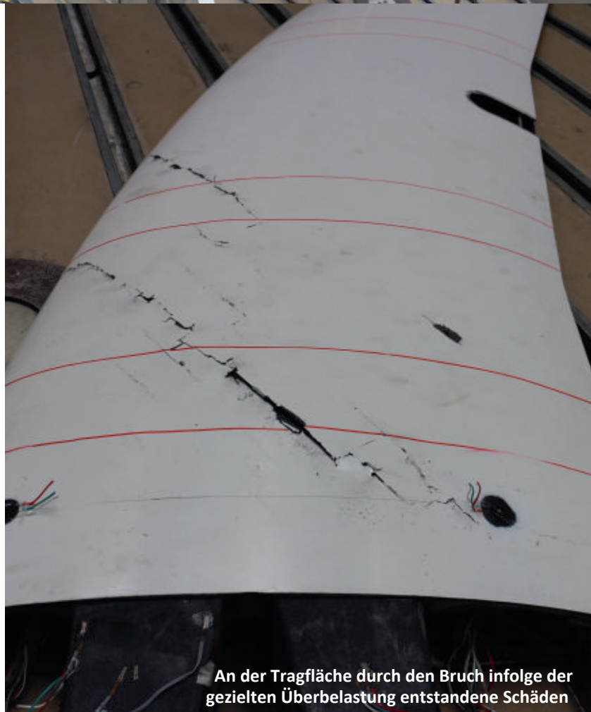
Test-Tragfläche unter hoher Belastung während des Bruchversuchs. Das Durchbiegen des Flügels ist deutlich zu sehen
