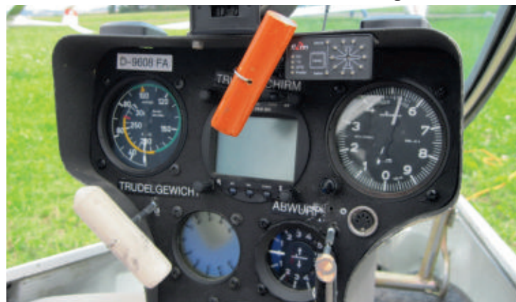
Betätigungsgriffe zur Öffnung des Gewichtskastens bzw. für Schirmöffnung und-abwurf
