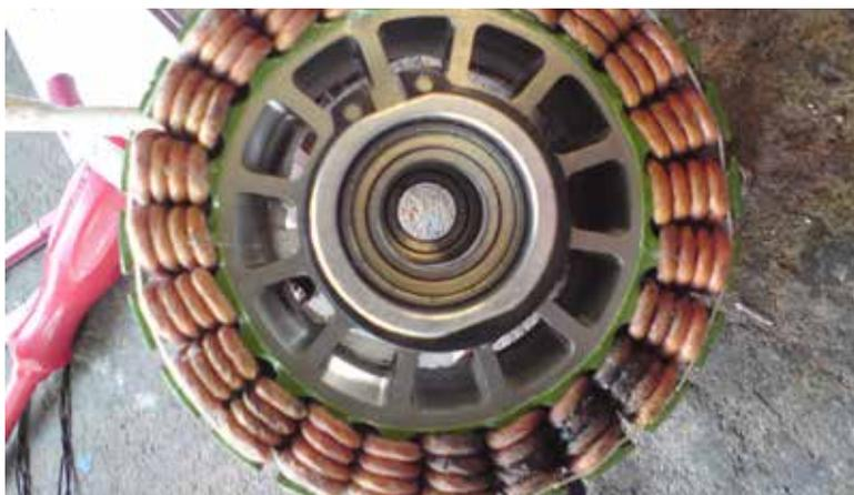
Motor mit einer durchgeglühten Statorwicklung
