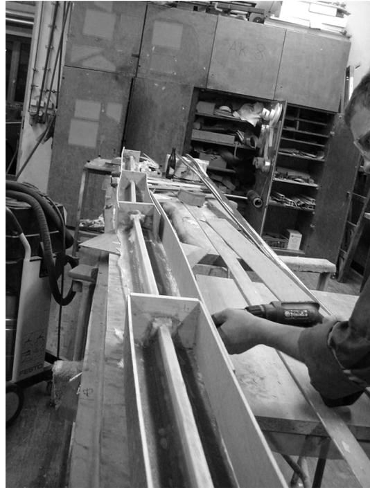
Abbildung 1.3: *Bau einer neuen Gurtform*
