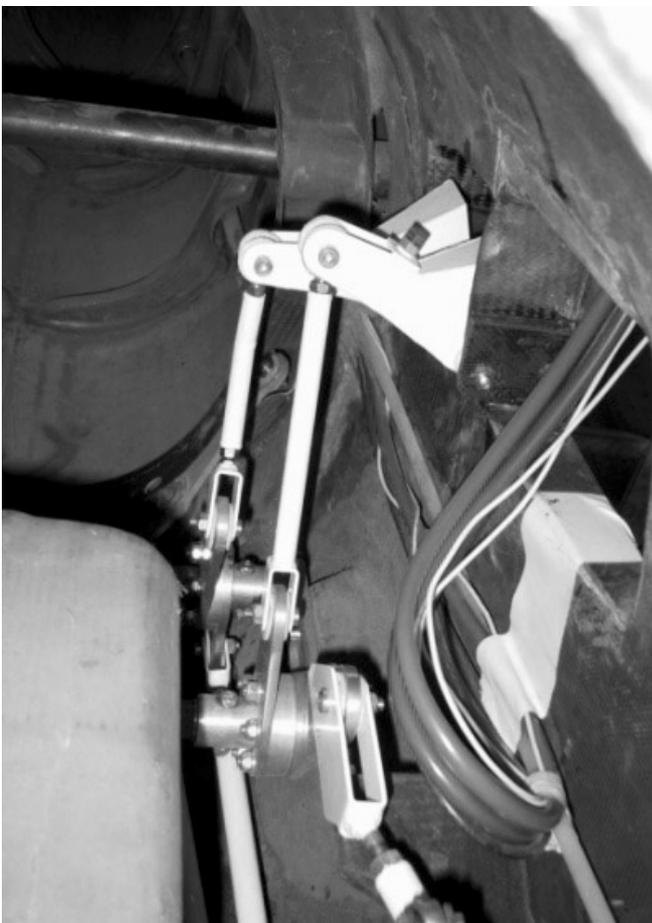
*Die montierten Steuerungsteile im Rumpf der AK-8*
