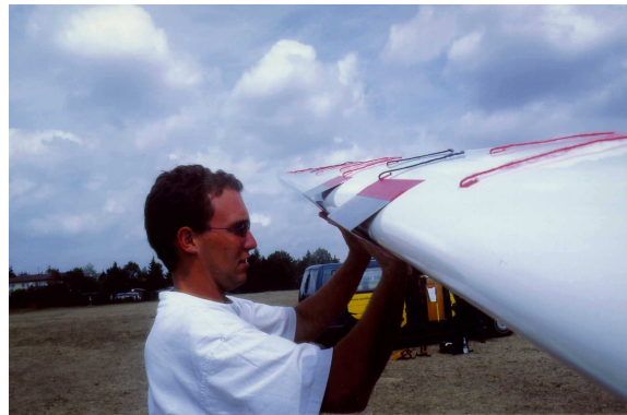
Abbildung 1.16: ASK-21 Tragflügel mit Dreiecksleisten
