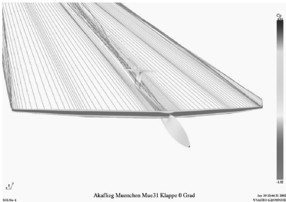
Abbildung 1.13: Gerechnete Druckverteilung auf der Oberfläche und Flügelnachlauf der Mü-31
