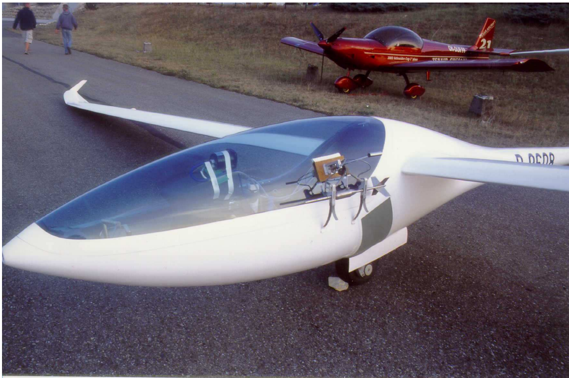
Abbildung 1.4: Die AK-8 mit Schleppsonde zur Kalibrierung der Fahrtmessanlage
