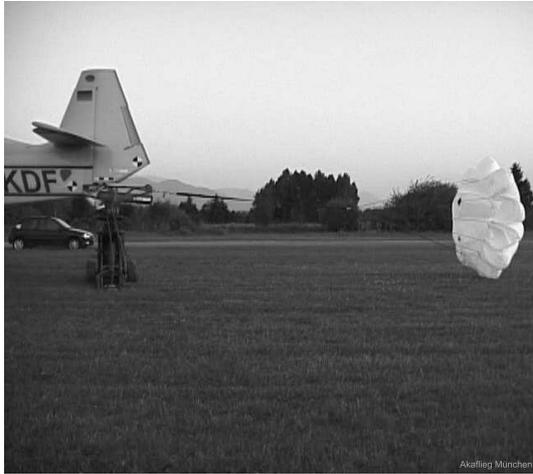
Abbildung 1.17: 2,08 Sekunden nach Ejektion des Schirmes
