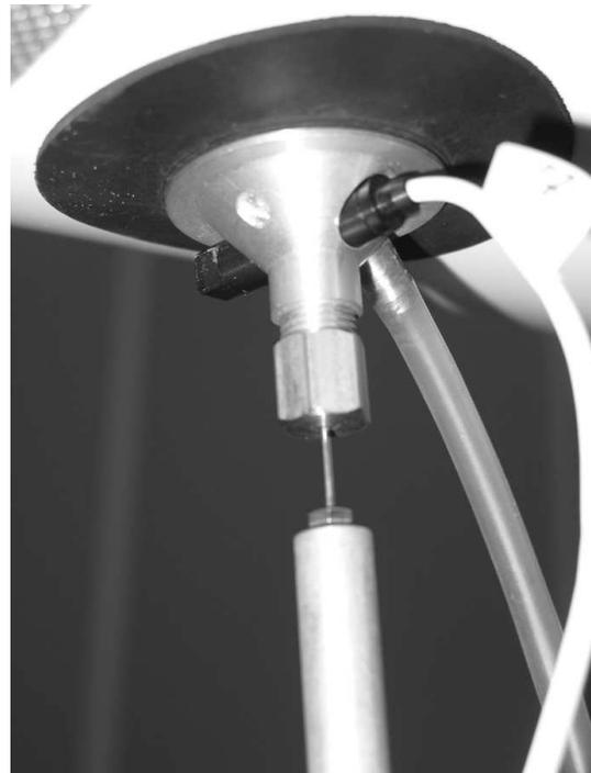
Abbildung 1.10: Saugkopf an der Rumpfunterseite mit Beschleunigungssensor und Sollbruchstelle
