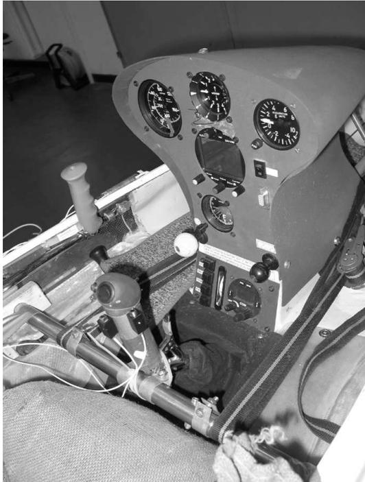
Abbildung 1.6: Instrumentenpiz und Steuerknüppelarretierung
