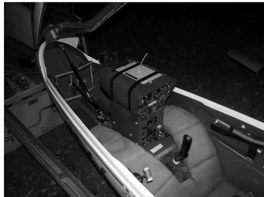
Abbildung 1.4: Die Antenne der Sendeeinheit in der Ak-5b (die Sendeeinheit befindet sich im Instrumentenpils)
