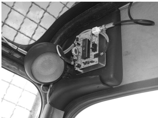
Abbildung 1.3: Die Empfangseinheit in der AFK-3
