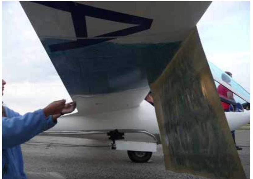
wird eine Folie über den eingefärbten Flügelabschnitt von 1m gelegt und mit einer Schnur mit dem Schleppseil verbunden. Mit dem Ausklinken wird die Folie vom Tragflügel gezogen; die Farbe beginnt erst zu fließen und dann zu trocknen. Zur Dokumentation ist eine GoPro Kamera am Rumpf montiert, da am Boden nur das Endergebnis nach der Trocknung zu sehen ist.
