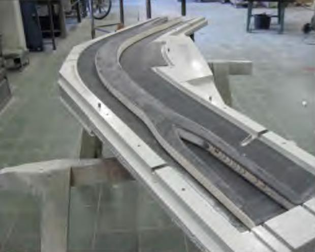
*Links:* Fertiger Holm, mit Sperrholz an den Seiten verstärkt
