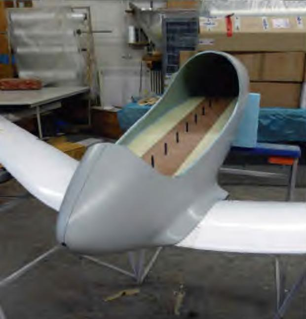
*Links:* Rumpf für den Standschwingversuch mit Aufnahmen für Gewichte zur Schwerpunktsänderung
