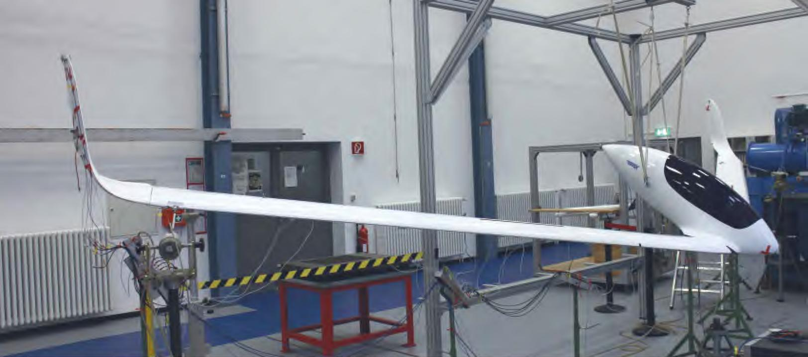
Modell in der Versuchshalle des Instituts für Aeroelastik vom DLR Göttingen beim Standschwingungsversuch. Man sieht die Verkabelung der zahlreichen Beschleunigungssensoren.
