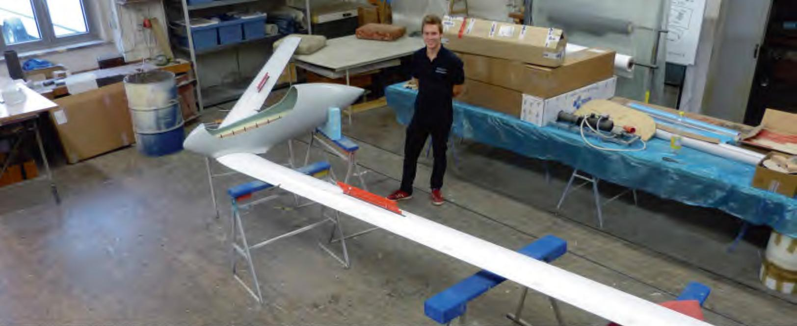
Das 1:2 Modell im Rohbau nach dem ersten Zusammensetzen von Rumpf und Flächen
