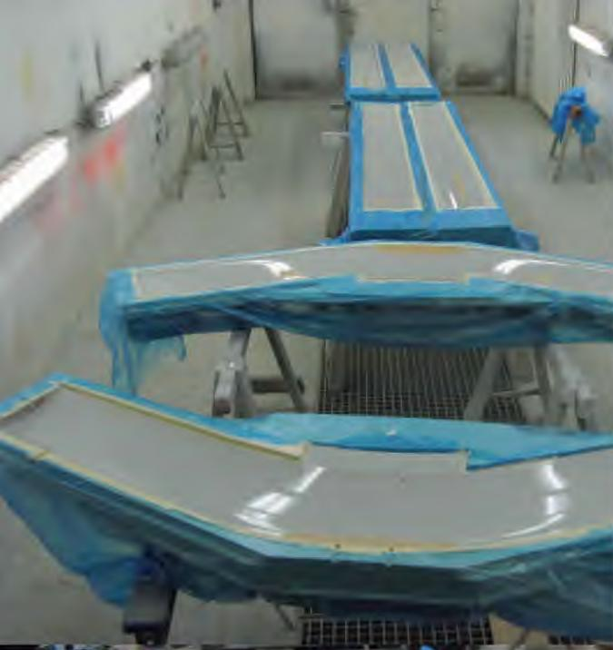
*Links:* Eingetrennte Formen in der Lackierkabine. Spätere Aussparungen wurden mit Wachsplatten vorbereitet.
