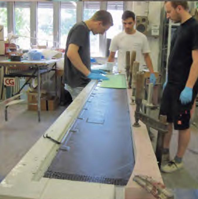
*Links:* Fertiges Außenlaminat. Gerade wird der Stützstoff für den Außenflügel angepasst.
