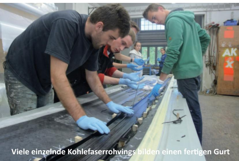
Viele einzelne Kohlefaserrovings bilden einen fertigen Gurt
