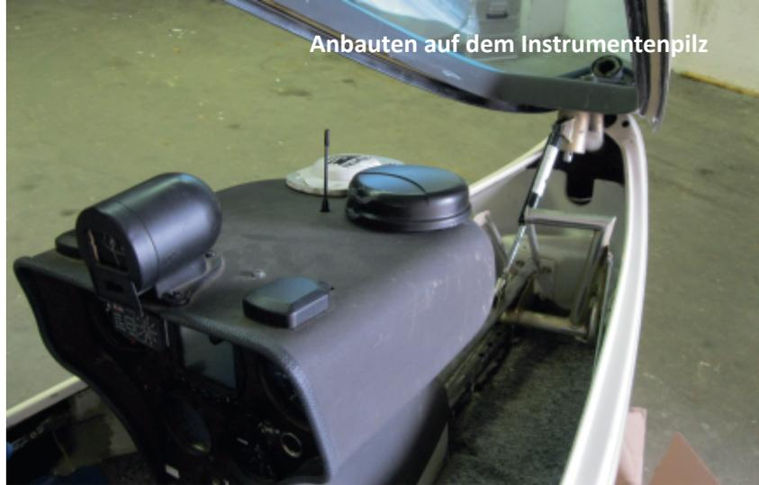
Messflüge mit den neuen Winglets durchgeführt werden. Dazu wurde die AK-8 mit einer Messanlage ausgestattet, um so im Vergleichsflug mit dem Discus2c DLR vermessen zu werden. Wie schon bei der Vermessung im Jahr 2012, hatte die AK-8 an derselben Position auf der Unterseite der Flächen Zackenband aufgeklebt.
