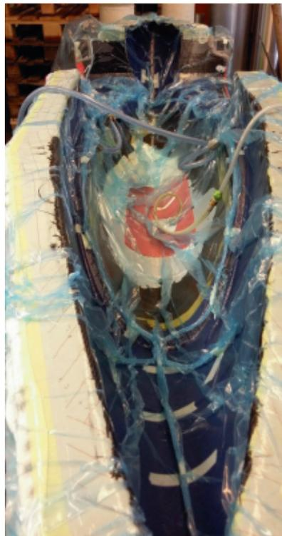
Infiltrationsprozess der Rumpfschalen
