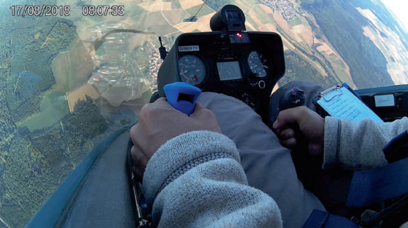
Abb. 1: Sicht aus dem Cockpit bei der Erprobung der Luftbremsenwirkung bei hoher Geschwindigkeit
