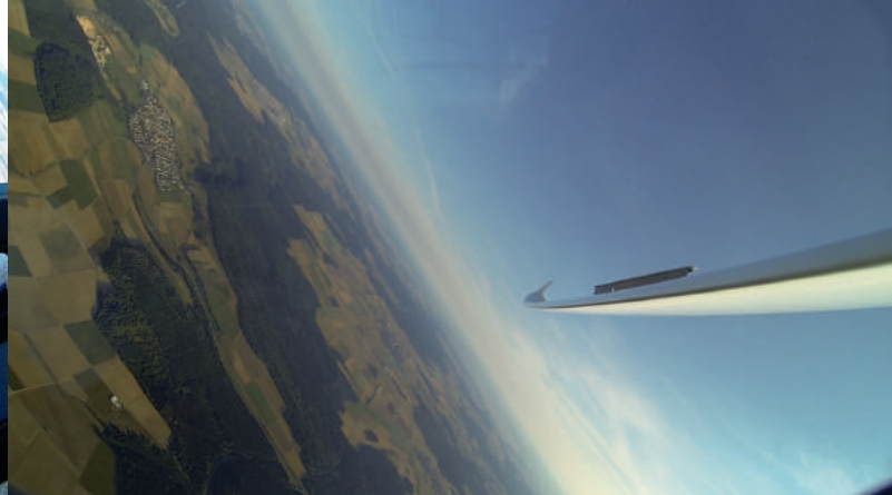
Abb. 2: Sicht auf den Flügel bei der Erprobung der Luftbremsenwirkung bei hoher Geschwindigkeit
