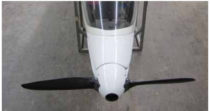
Elektromotor mit Spinner, Propeller ausgeklappt
