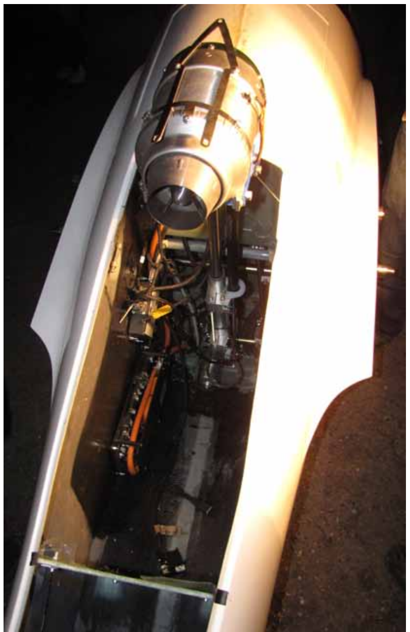
Modellturbine bei ersten Lauftests
