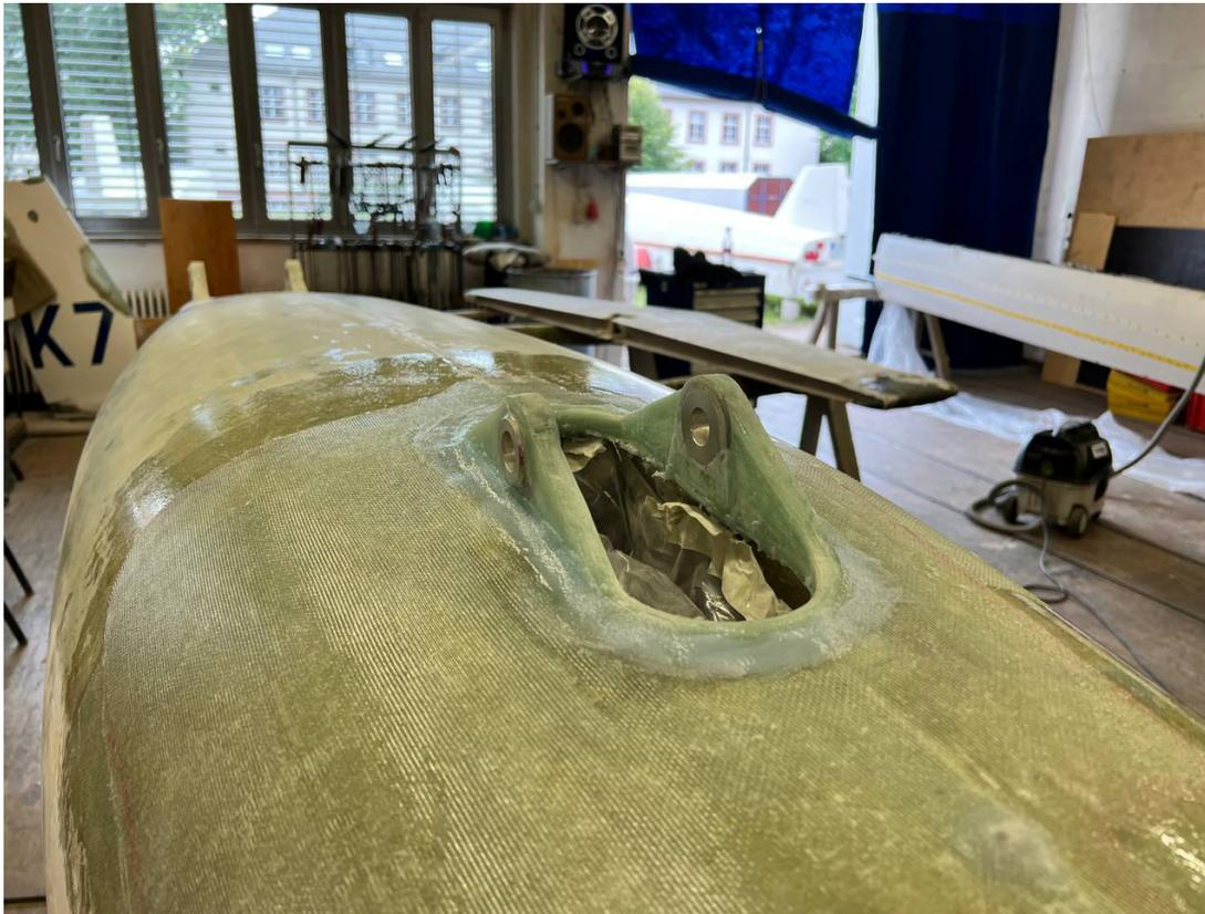
Einbau der neuen Bugradaufhängung
