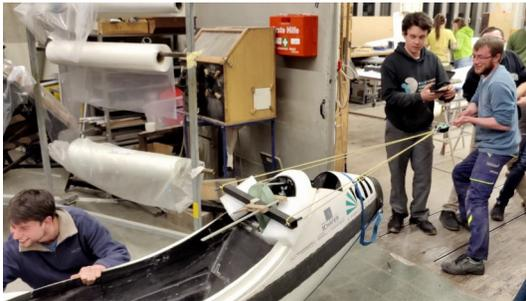
Belastungsversuch der Kopfstütze
