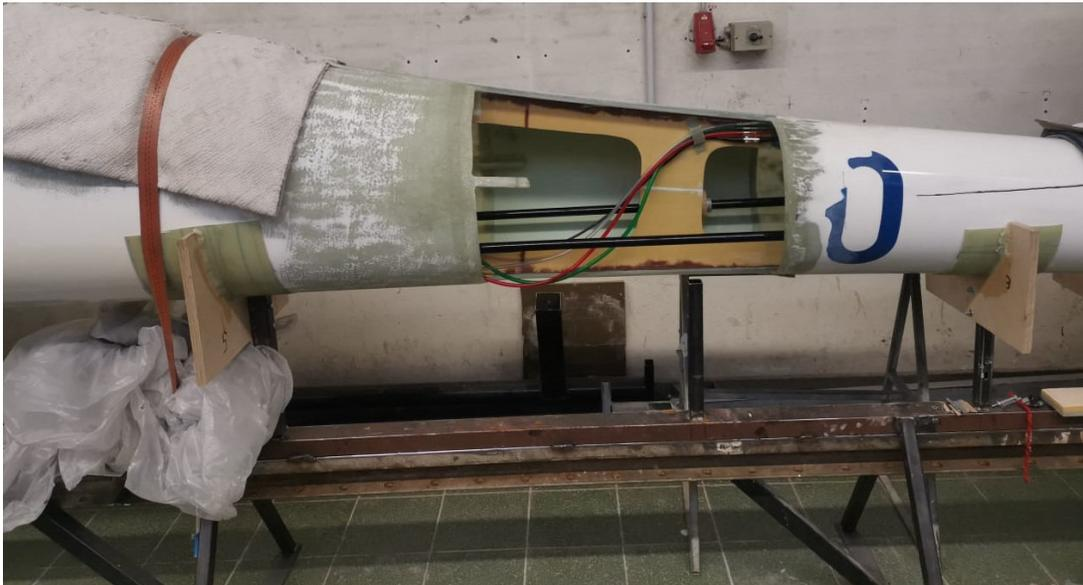
Der Rumpf in der Helling mit den bereits eingebauten Steuerstangen, dem Steg, Druckschläuchen und dem Antennenkabel
