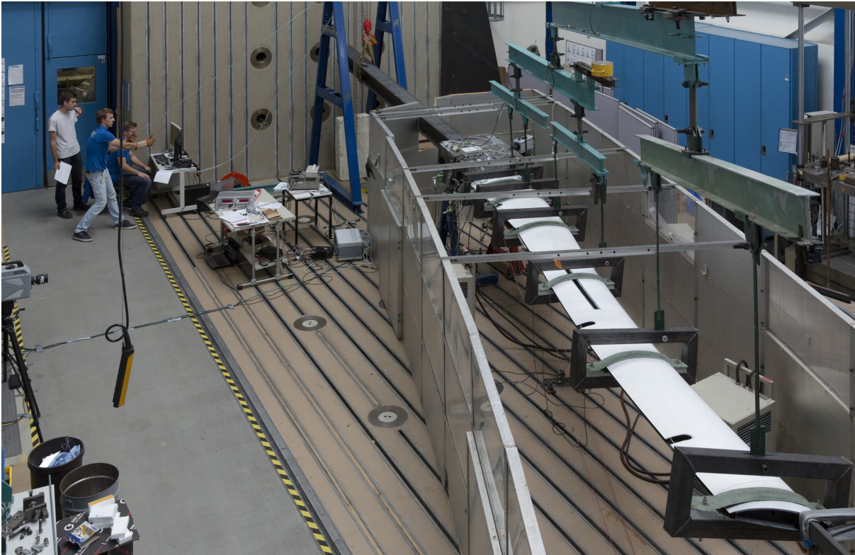
Abbildung 5 Flügelbruchversuch beim Deutschen Zentrum für Luft und Raumfahrt
