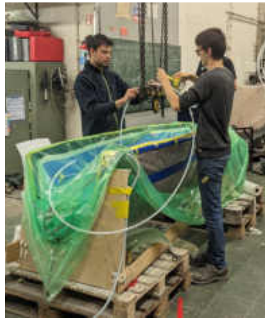
Vakuuminfusion der Tiefziehform für die Haube
