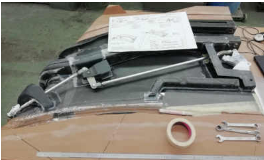
Einbau der Steuerung ins Winglet
