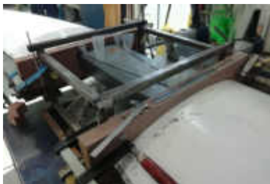
Aufbau zum Bohren der Tragflächen
