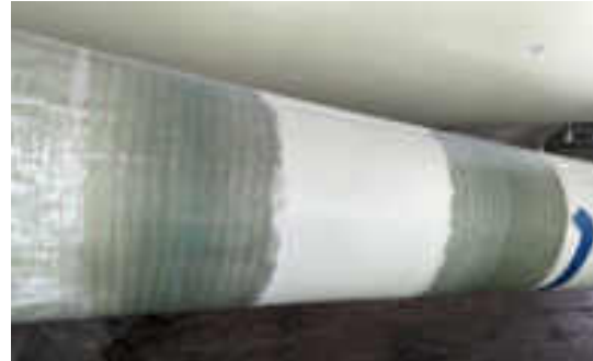
Die fertigen Rumpfschäftungen zur Verbindung des Seitenleitwerks mit dem vorderen Rumpfteil
