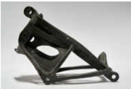
Erste Version der Bugfahrwerksgabel aus CFK
