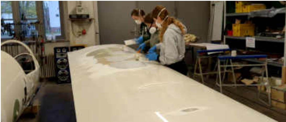
Lackieren der Reparatur an der linken Fläche
