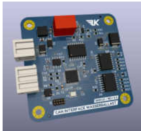
Steuerplatine für den Wasserballast
