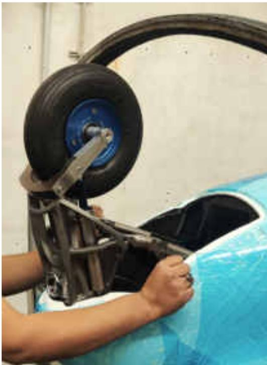
Testeinbau des Bugfahrwerks
