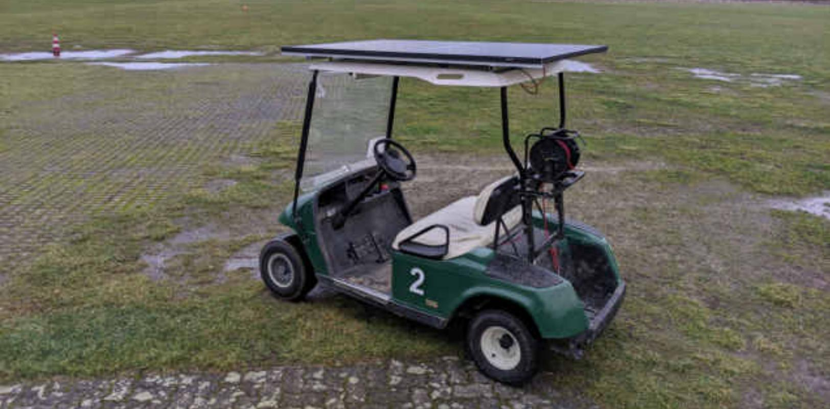
Eines der Golfcarts mit einem Solarmodul
