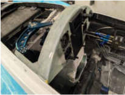
Testeinbau des Instrumentenbretts
