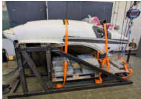
Rumpfbelastungsversuch mit Lastfall -4,5 g
